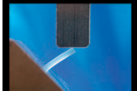
Test für statische Bruchfestigkeit
